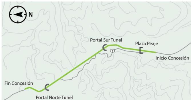
El mejoramiento del actual túnel Túnel El Melón incluirá la construcción de nuevos accesos, la ampliación de su altura actual y la modernización de los mecanismos de ventilación, iluminación y sistemas de gestión de tráfico.
